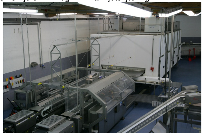
Figure 10. Fileteringslinje med CBC-kjøler og vannjetskjæring.
