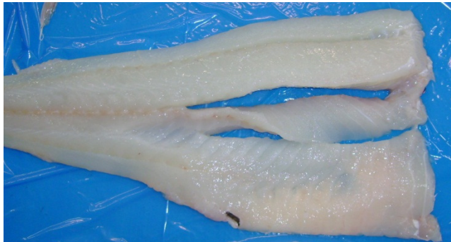
Figure 12. Skjæring av tykkfiskbein ut filet med vannjet.
