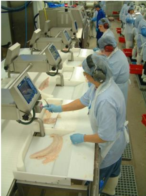
Figur 13. Manuell fjerning av tykkfiskbein i torsk
